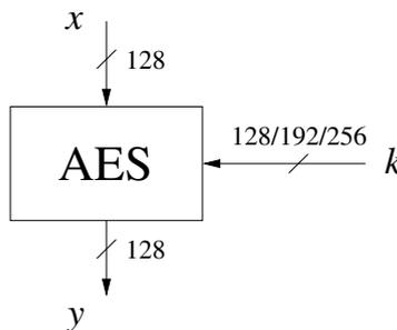
**Fig. 4.1** AES input/output parameters
