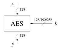
Fig. 4.1 AES input/output parameters
